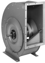
Spiralformgehäuse, verzinkt oder geschweißt und beschichtet, in unterschiedlichen Bauformen, unterschiedlichen Wälzlagern und unterschiedlichen Gehäuse-Verstärkungsrahmen ausgestattet. Je nach Ausführung mit Lagern innerhalb oder außerhalb des Förderstromes. Eingebautes Radiallaufrad mit rückwärtsgekrümmten, aerodynamisch geformten Hohlprofilschaufeln aus Stahlblech geschweißt und beschichtet, statisch und dynamisch gewuchtet.
