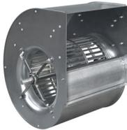
Spiralformgehäuse verzinkt, mit unterschiedlichen Wälzlager und unterschiedlichen Gehäuse-Verstärkungsrahmen ausgestattet. Eingebautes Trommellaufwerk mit vorwärtsgekrümmten Kreisbogenschaukeln, im Falzverfahren gefertigt, statisch und dynamisch gewuchtet.
