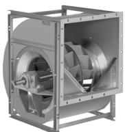
Spiralformgehäuse, verzinkt oder geschweißt und beschichtet, mit unterschiedliche Wälzlager und unterschiedlichen Gehäuse-Verstärkungsrahmen ausgestattet.
