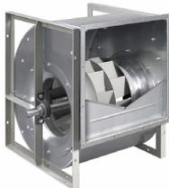
Spiralformgehäuse verzinkt, mit unterschiedlichen Wälzlager und unterschiedlichen Gehäuse-Verstärkungsrahmen ausgestattet. Eingebautes Radialaufwerk mit rückwärtsgeneigten Schaufeln aus Stahlblech geschweißt und beschichtet, statisch und dynamisch gewuchtet.
