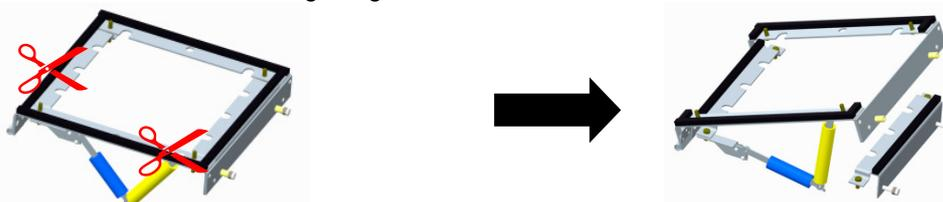
9. Klapprahmen-Gelenk durch Hochschieben des Sicherungsrohres ⑦ entriegeln und Klapprahmen mit Ventilator vorsichtig schließen.
