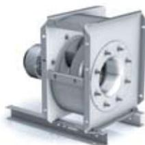
einseitig saugend, saug- und druckseitig mit Flansch für den Kanalanschluss, Motor von Förderstrom getrennt.
