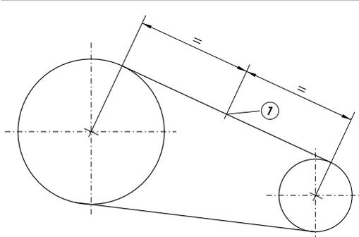
Eine weitere einfache Methode zur Einstellung bzw. Prüfung der richtigen Riemen Spannung erfolgt über die statische Frequenz des Antriebsriemen. Hierbei wird der Flach- bzw. Keilriemen im Stillstand durch Anschlagen in Eigenschwingung versetzt. Diese Schwingung wird mit einem elektronischen Meßgerät (z.B. Trummeter) gemessen. Die Schwingung in Hz ist auf den angegebenen Wert (Dokumentation / Typenschild) einzustellen.
