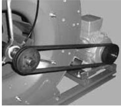
Hochleistungs-Schmalkeilriemen nach DIN 7753 sind temperaturbeständig bis +80 °C, widerstandsfähig gegen Mineralöle und sind elektrostatisch leitfähig. Die Riemenscheiben sind aus hochwertigen Grauguss hergestellt und in Abhängigkeit von Umfangsgeschwindigkeit und Rillenzahl statisch (G 16) oder dynamisch (G 6.3) gewuchtet. Die Befestigung auf der Motor- bzw. Ventilatorwelle erfolgt mittels Spannbuchsen.
