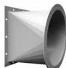
Übergangsstück (eckig/rund) zur Anpassung an unterschiedliche Leitungsquerschnitte, aus Stahlblech geschweißt und beschichtet, zugelassen für 600 °C - 120 min. und zertifiziert.
