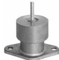
Feder-Schwingungsdämpfer mit Körperschalleinlage und Höhenverstellung, für Drehzahlen über 400 1/min zur Schwingungs- und Körperschallisolierung. Zuordnung der Schwingungsdämpfer zu den Ventilatorotypen siehe Preisliste. Die Schwingungsdämpfer werden grundsätzlich mit dem passenden Befestigungsmaterial für den entsprechenden Grundrahmen geliefert.
