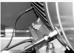
Lagerüberwachung durch Stoßimpulsmessung auf Anfrage.
