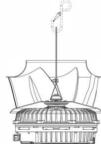
1. Hebehilfe – 2. Sicherungsschraube – 3. Sicherungsmutter
