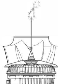
1. Lyftanordning 2. Lyftanordning 3. Säkringsmutter
