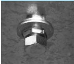
Se il ventilatore viene collocato all'aperto o utilizzato per trattare aria umida, è possibile che all'interno della coclea si raccolga condensa. Per scaricare la condensa è necessario applicare un raccordo di scarico nel punto più basso della coclea, dotato di una filettatura per l'eventuale collegamento di un tubo di scarico. Al momento dell'ordine è indispensabile indicare la posizione richiesta per lo scarico.
