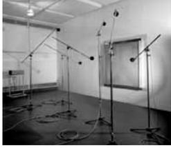
Le misurazioni dei livelli di potenza sonora sono state svolte in accordo alla norma DIN 45635-38: "Misurazione dei rumori delle macchine; ventilatori".
