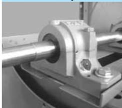
Per il fissaggio dei sensori di vibrazione, è possibile dotare alcuni supporti dei cuscinetti di un foro filettato M6 o M8.
